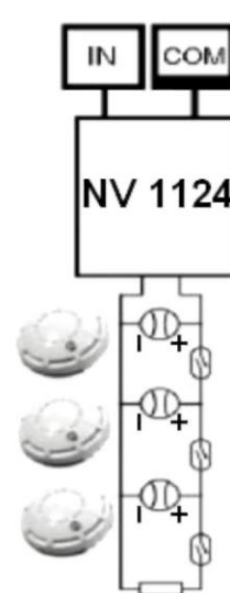
шлейф пожарных двухпроводных извещателей
